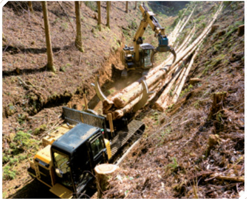
スキッダでの間伐・搬出作業
